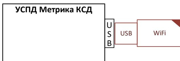
Рисунок 15 — Схема подключения WiFi точки доступа к УСПД
