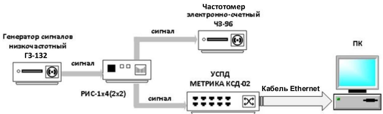
Рисунок А.2 - Схема включения УСПД при поверке для определения относительной погрешности измерений количества импульсов
